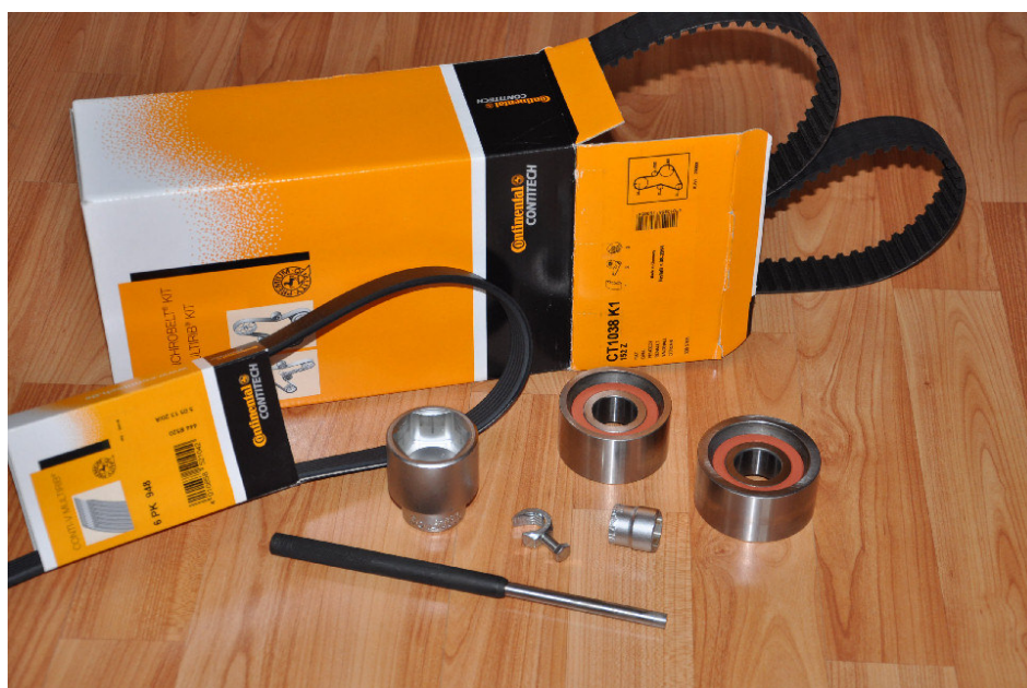
Zahnriemenkit mit Umlenk- und Spannrolle, Keilrippenriemen, 36er Nuss, aufgesägte 14er Mutter mit Griff, 17er Nuss beidseitig gekürzt und 8mm Durchschlag
