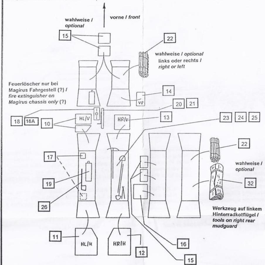
Brechstange und Hammer nicht dokumentiert. Die Brechstange könnte rechts am Fahrzeugrahmen unterhalb der Seitenluke angebracht gewesen sein / crowbar and hammer not documented. The crowbar may be fitted on chassis frame below right side hatch
