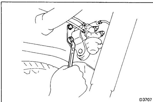
(b) Die Befestigungsschrauben des Ventilträgers ausbauen und den Bremskraftregler-Zusammenbau abbauen.
