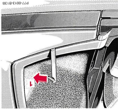
4. Linken Verschluss des Verdeckkastendeckels entriegeln: Gabelschlüssel auf den Bolzen zwischen Überrollbügel und Verdeckkastendeckel aufstecken. Gabelschlüssel nach hinten drücken (1). Verdeckkasten- deckel aus der Verriegelung herausziehen.
