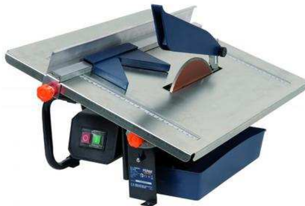
afb.16.4 - 3 Tegelzaag, met watergekoeld diamantblad
