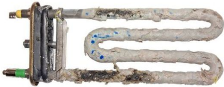
Afb. 10.1.6 – 5 Verwarmingsselement van een wasmachine, met kalkaanslag. De warmteoverdracht is drastisch gereduceerd. -> washing machine heating element with alkaline incrustations, heat transfer drastically reduced
