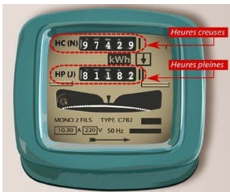
afb. 13.1.1 - 2 Conventionele mechanische meter, hier met double tarif
