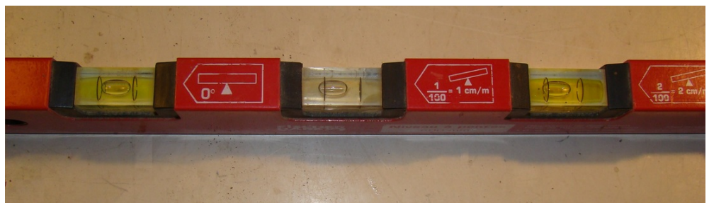
afb. 10.2.2 - 3 Hellingwaterpas detail. Links: geen helling, midden: helling 1 op 100 of 1%, rechts helling 2 op 100 of 2% (of 1 op 50)
