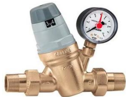
afb. 10.1.5 - 2 Regulateur de pression, hier ingesteld op 3,5bar (zie het kleine zwarte venster met een waarde tussen 3 en 4) en met de rode waarschuwingwijzer op 5bar
