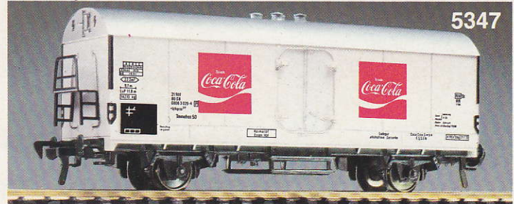
5347 · Kühlwagen, Modell des Ichqs 377 der DB, LüP: 137 mm, mit 2 beweglichen Doppeltüren, vorbildentsprechende "COCA-COLA"-Lackierung und Beschriftung.
