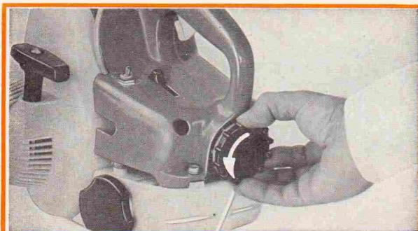
Zadaća prečistača – filtra – zraka je da zadrži prašinu iz usisanoga zraka i na taj način umanji trošenje (habanje) dijelova pogonskoga uredjaja koji su izloženi trenju.
