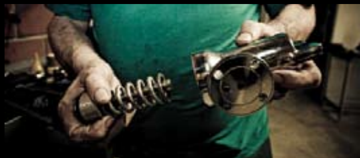
Die mechanischen Einzelteile werden in der Werkstatt per Hand gefertigt und zusammengesetzt. Für idealen und reproduzierbaren Druck für den Espresso sorgt eine starke Feder im Kolben der Maschinen (Bild rechts oben).
