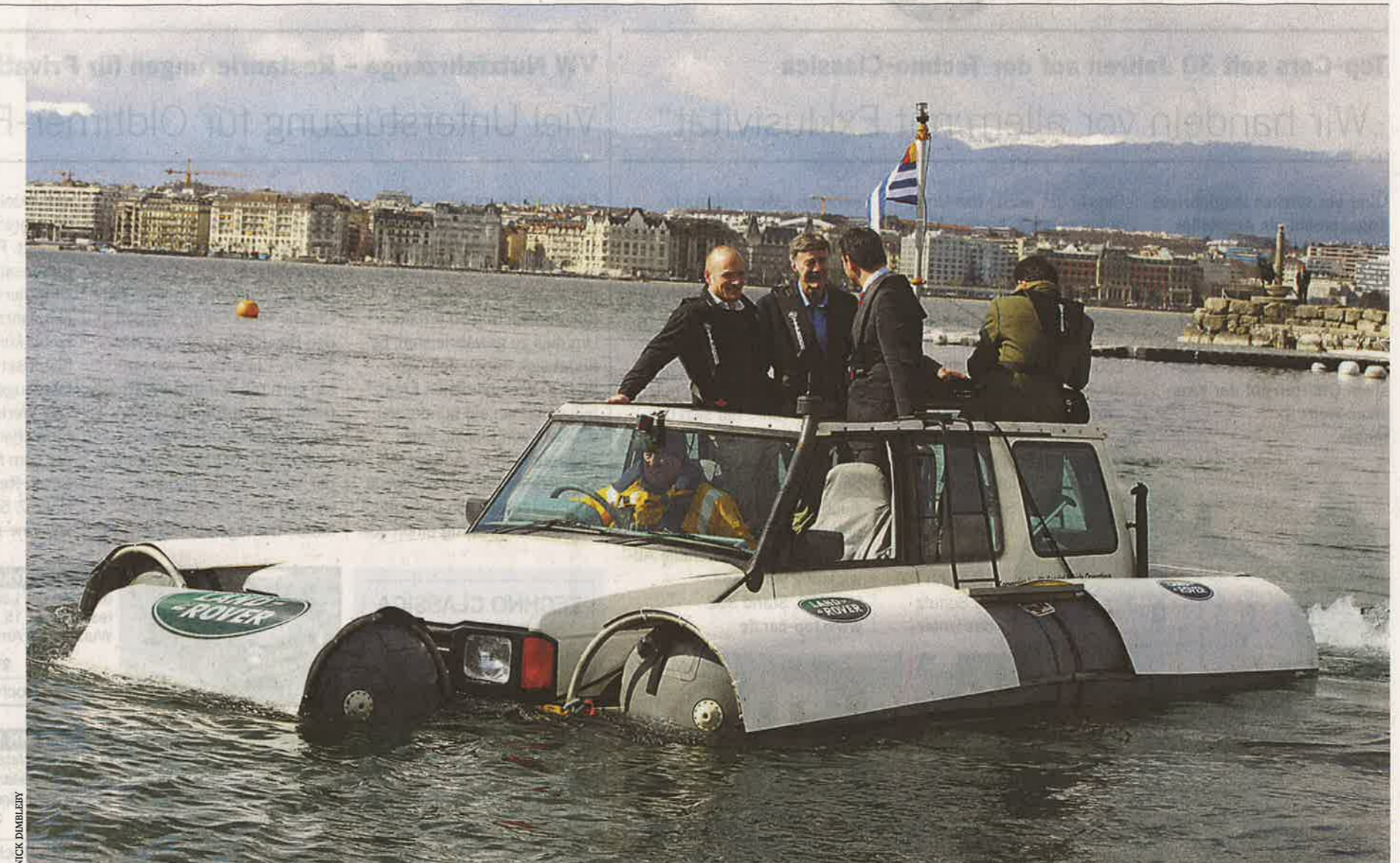
Spritztour auf dem Genfer See: Der Land Rover Discovery ist mit Schwimm tanks und Positionsleuchten ausgestattet. Räder hat er dennoch, er muss ja ins Wasser fahren können
