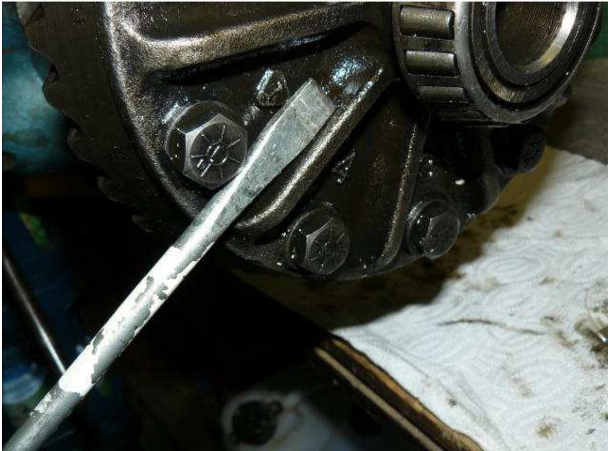
Irgendwann sind die Kegelräder und die Scheiben einigermaßen in der richtigen Position, durch die Löcher peilen und die Scheiben und Kegelräder ausrichten, bis sich der Herzbolzen leicht einschieben läßt. Den Herzbolzen temporär mit der Halteschraube sichern, damit er nicht herausfällt.
