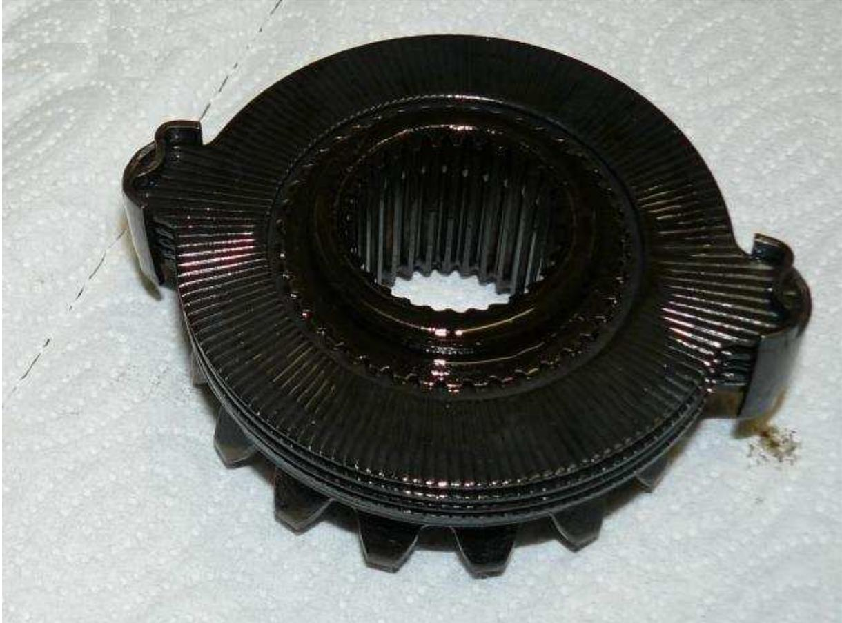
Das linke Antriebskegelrad komplett mit den Trac-Lok-Scheiben in den Korb einsetzen, darauf achten, daß die Klammern nicht herunterfallen. Dann dieses Antriebskegelrad mit der Schraube sichern, leicht anziehen.
