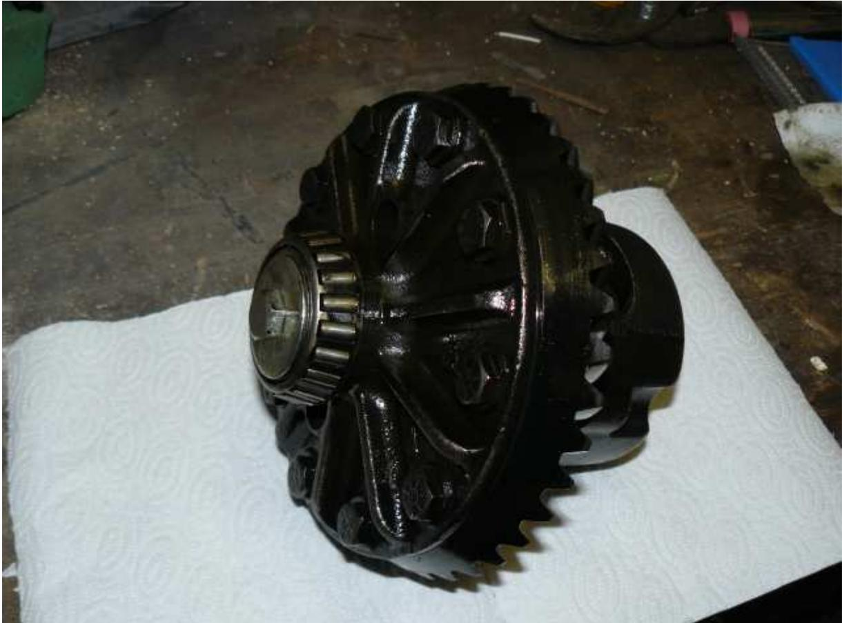
Jetzt die oberen und unteren Kegelräder gegeneinander drehen, dabei werden sie sich aus dem Korb bewegen. Merken, auf welcher Seite jedes Kegelrad und die schüsselförmige Beilagscheibe gesessen hat. Die zwei Kegelräder entfernen.
