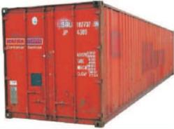
**Standard-Container aus Stahl: 20' lang und 8'6" hoch, mit gesickten Wänden und Holzboden**
