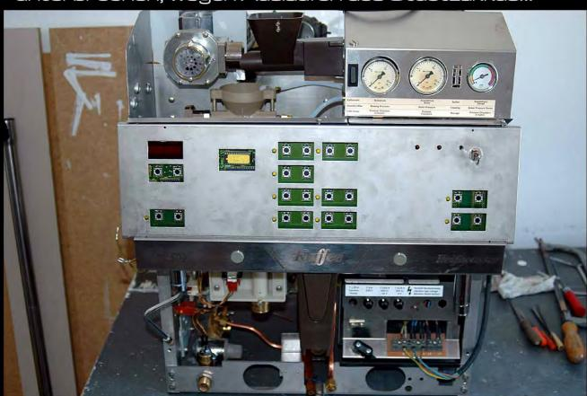
Nach der Reperatur der Bedienfrontplatte und Austausch der 3 Manometer erolgte nun endlich ein angenehmes Bild der erhofften Funktionstuechtigkeit.
