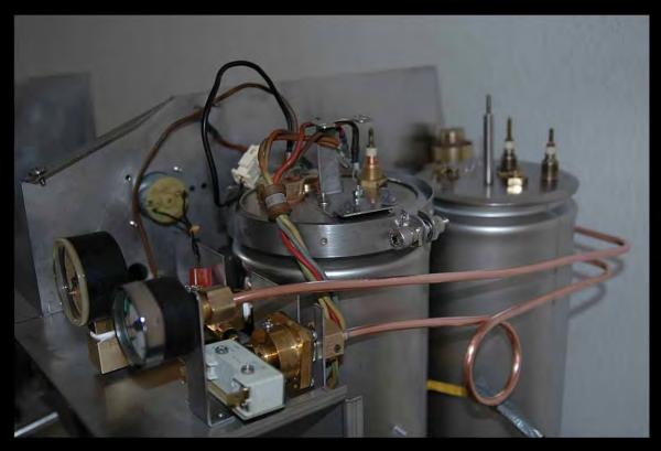
Platzhalter fuer den Brueher. Unten rechts auch ein Sicherheitsventil, darunter der Ablauf. Der Schlauch ist fuer die kleine Abluft - Anlage.
