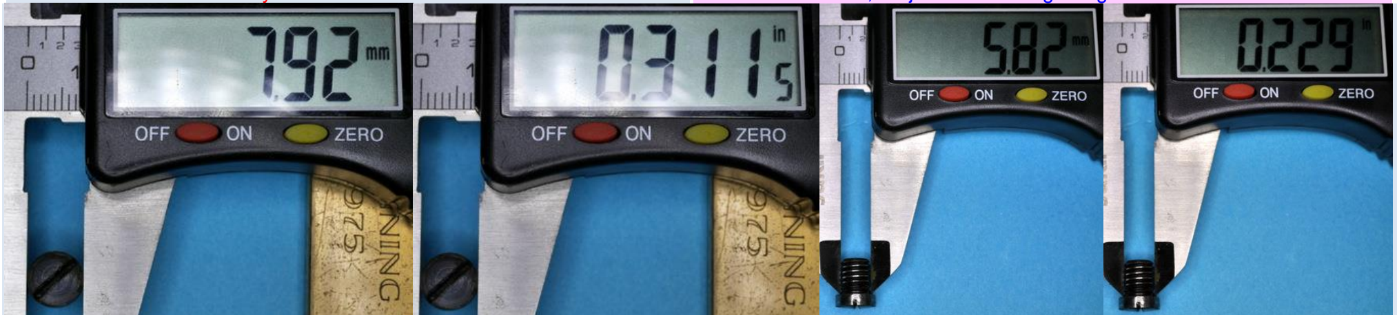
From left comparative views of 2 nd or beefy version butt screws: measurements of RNMA #13859 are shown first in millimeter then in inch/Von links vergleichende Ansichten der Griffbodenschrauben 2. bzw. fette Version: spezifische Messungen an RNMA #13859 erst in Millimeter, dann in Inch
