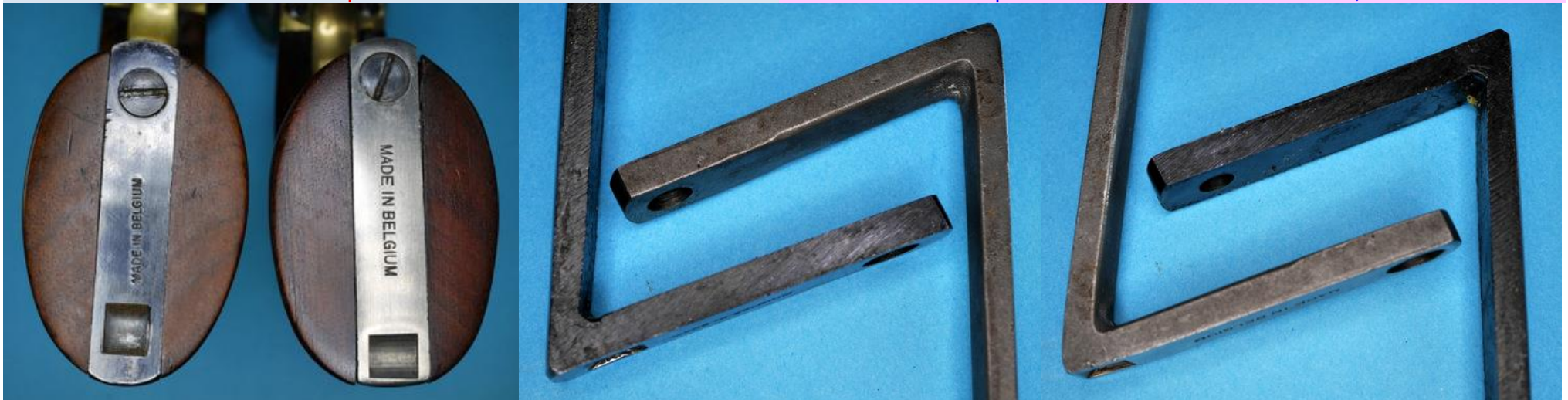
Comparative views from RNMA back straps #6374 and #13859 from left: 1 st or early "welded" version vs 2 nd or late "cast" version; cast over welded back strap/Vergleichende Ansichten der RNMA-Griffrückten von #6374 und #13859: 1. oder frühe "geschweißte" vs. 2. oder späte "gegossene" Version; gegossene Version oben, geschweißte unten; geschweißte Version oben, gegossene unten
