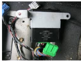
Steuergerät Allrad unter der Mittelkonsole
