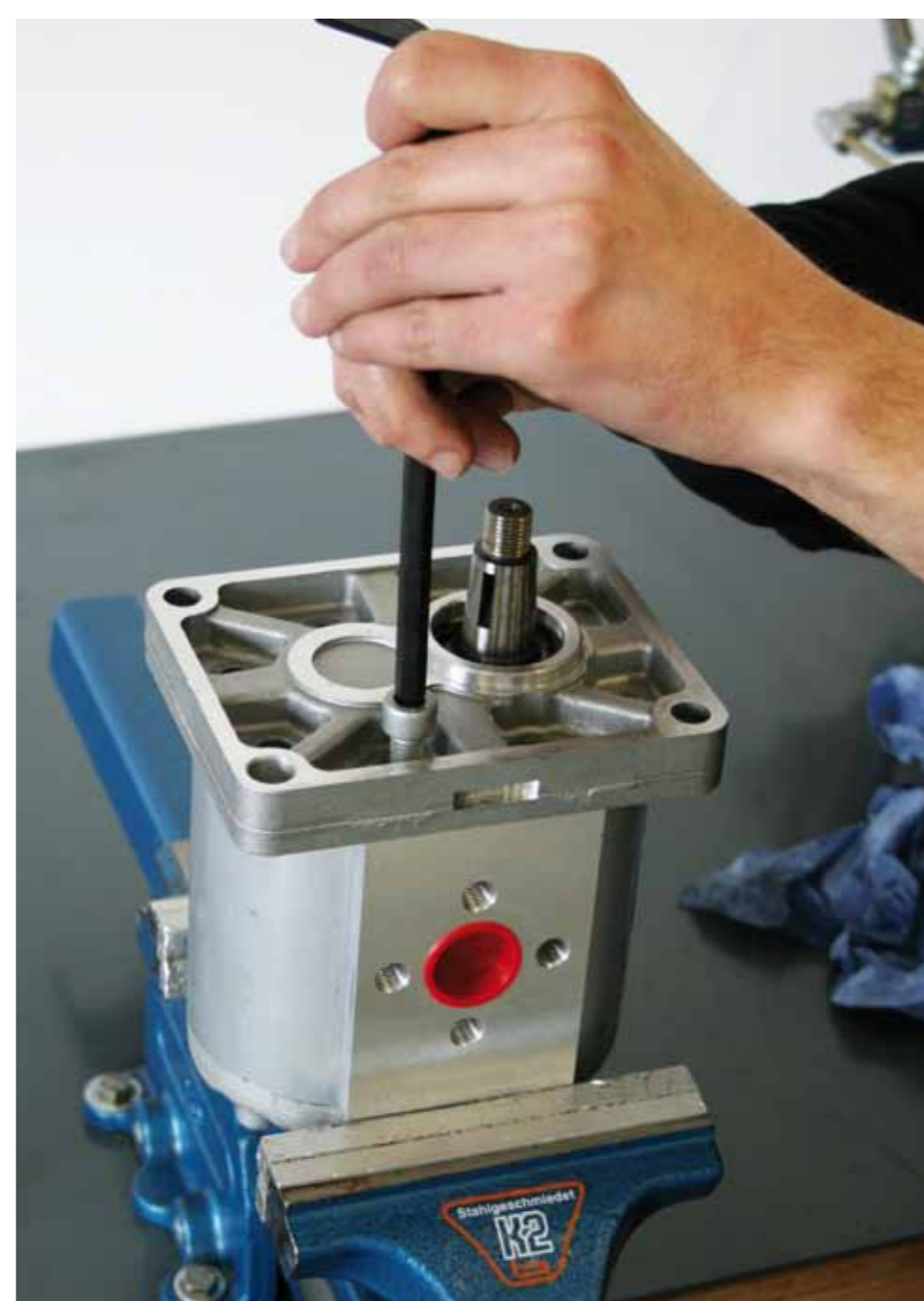
9. Deckel aufsetzen, Schrauben stufenweise überkreuzt anziehen
