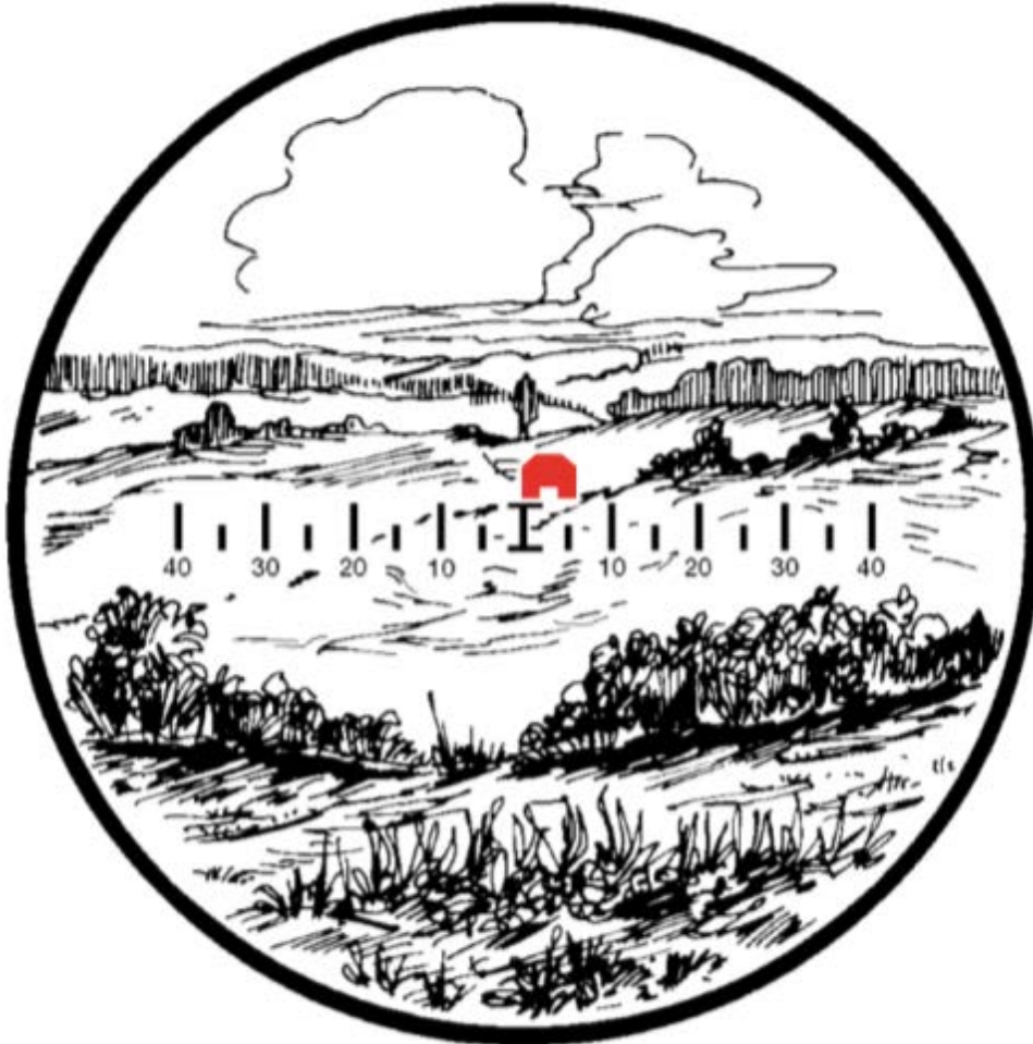
Bild 75 - Ermitteln der Entfernung mit Hilfe des Strichbildes
