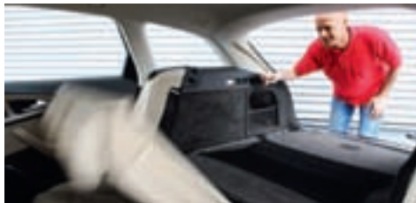
Nur einmal am Hebel ziehen, schon faltet sich die Rückenlehne nach vorne.
