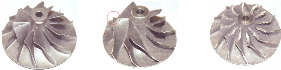
Bild 5 Zerstörte Turbinenschaufeln. Links, die Oberkante des Verdichterrades ist vom Fahren ohne Luftfilter stark aufgeraut. Mitte, sich ablösende Gummipartikel aus dem Saugrohr haben die Schaufeln an den Spitzen deformiert. Rechts, ein harter Fremdkörper, möglicherweise eine Schraube oder Unterlegscheibe, haben das Verdichterrad abgeräumt.
