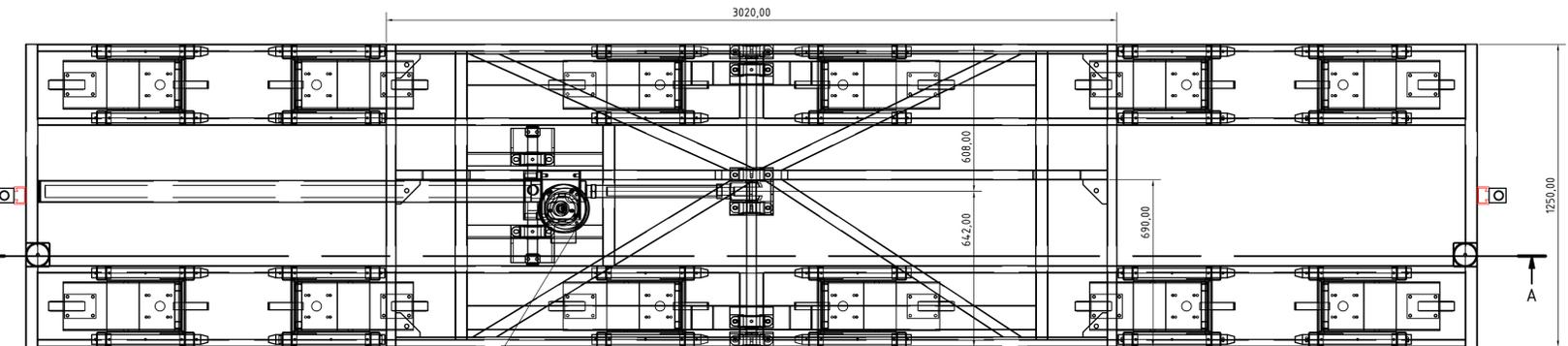
Motor kann aus nur stehend eingebaut werden, da er sonst zu weit seitlich in die Konstruktion ragt.
