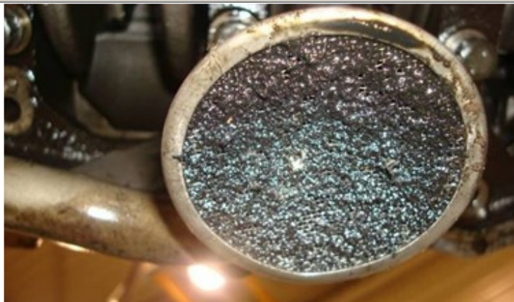
Ölsieb durch Ölverkohlung verstopft
