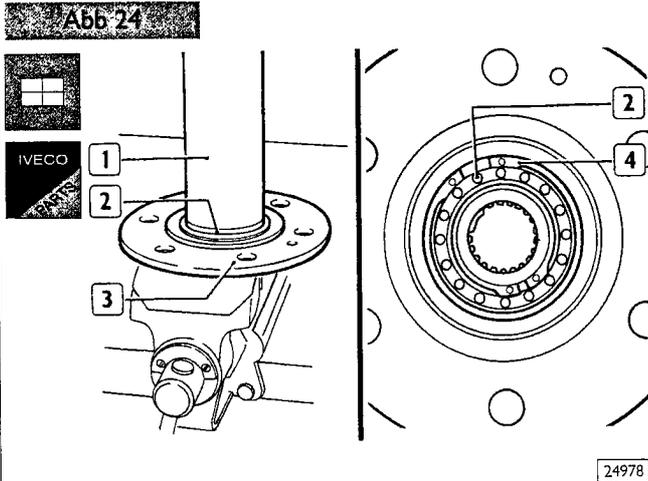
Das Lager (2) mit dem Schlagvorrichtung (1) zusammen mit der Verbindungswelle an dem unteren Körper (3) einbauen und diesen durch den Dichtring (4) festklemmen.
