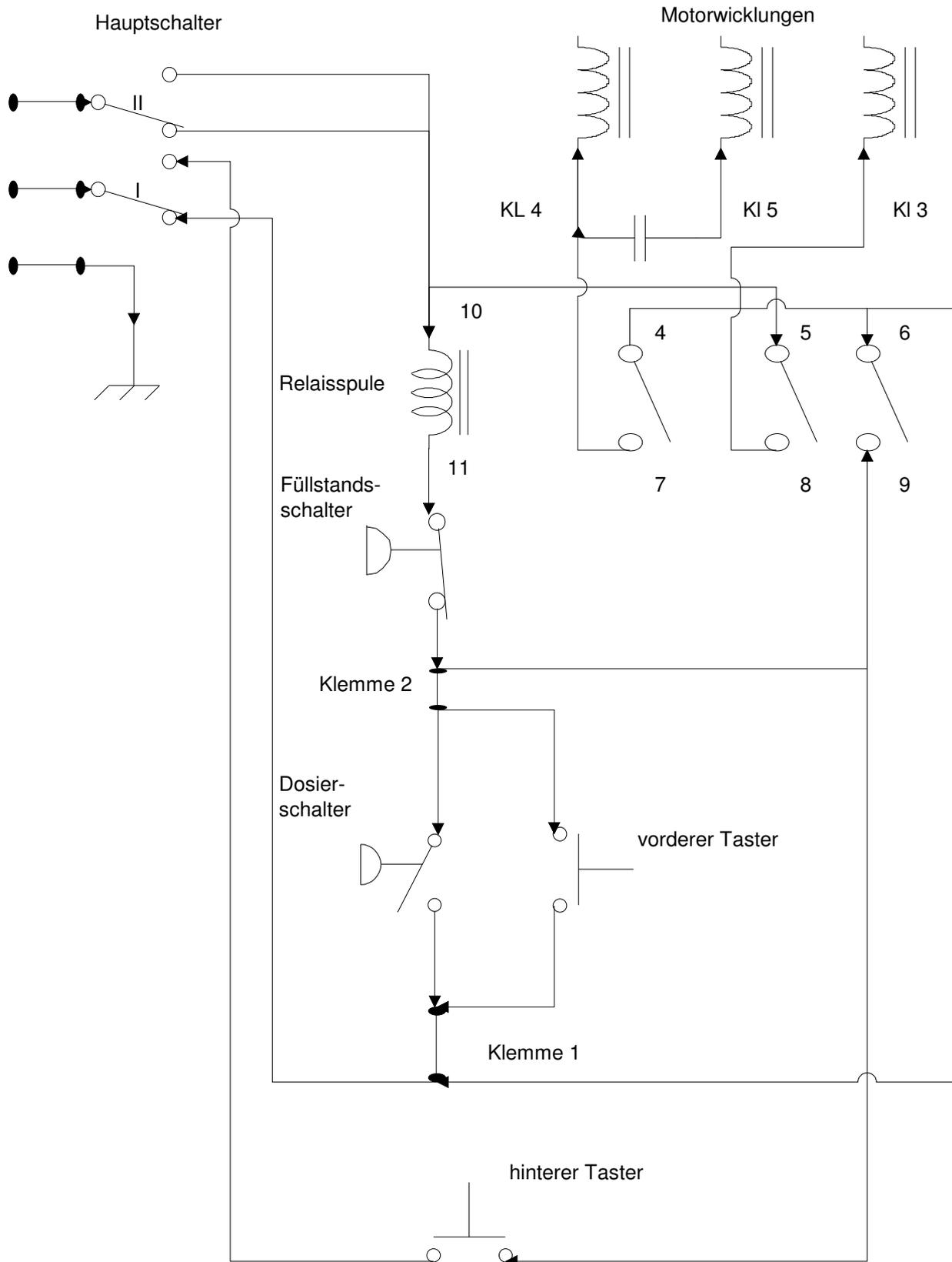
In der vorderen Stellung des Hauptschalters (Automatikbetrieb) kann mit Dosierschalter oder vorderem Taster die Mühle gestartet werden. Der Motor läuft mit Selbsthaltung über Relais bis der Füllstandsschalter ausschaltet.
