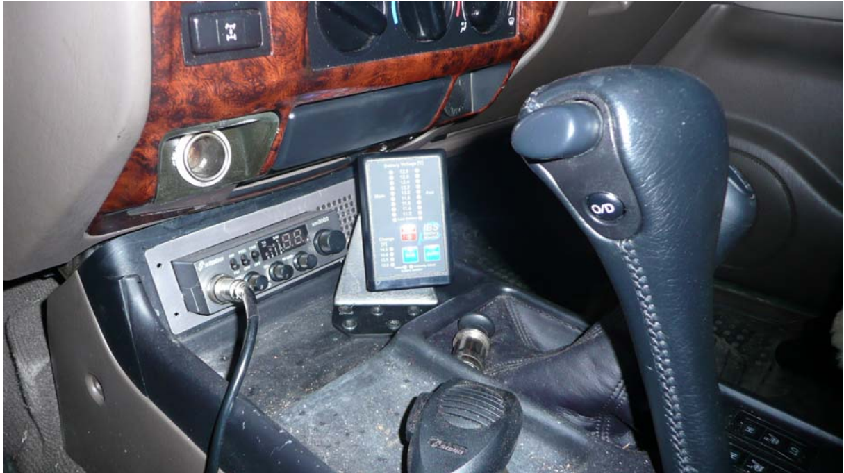
Kontrolle der Starter- und Bordbatteriespannung
