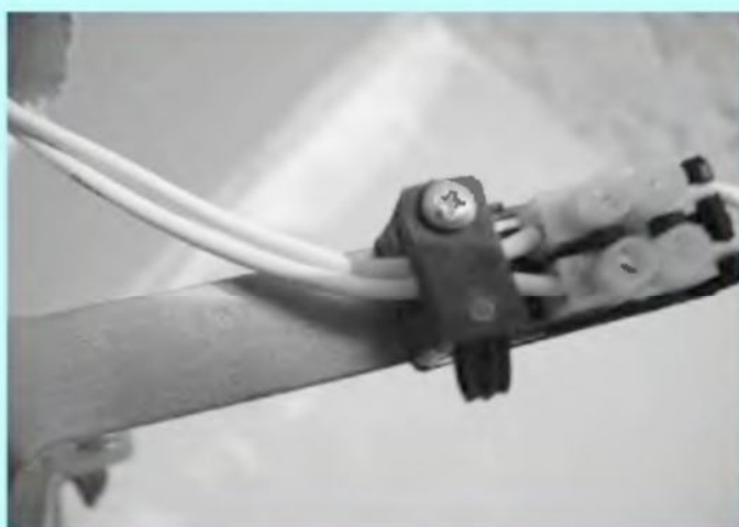
9 - Placez le serre-câble sur l'alimentation.
