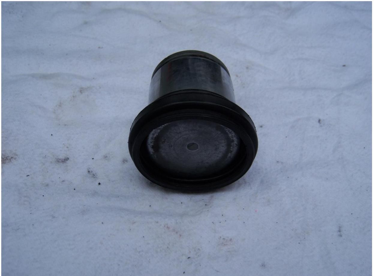
die Staubschutzmanschette so über den Bremskolben schieben
