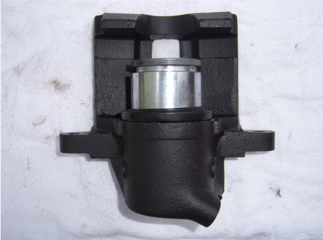
... und die Manschette mit dem Kolben in den Bremsattel einsetzen
